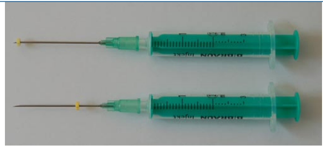
Abb. 3 ▲ Spritzen vor (oben) und nach Injektion (unten) mit Gummistopper (gelb). Der Gummistopper verbleibt nach der Simulation der Injektion am Punkt der maximalen Punktionstiefe und ermöglicht somit deren Messung
